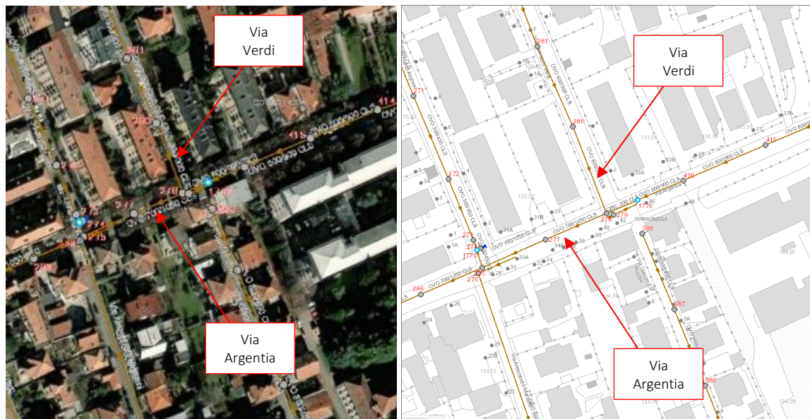
Figura 9 – Estratto dal webgis di CAP della rete fognaria nell'area d'interesse
