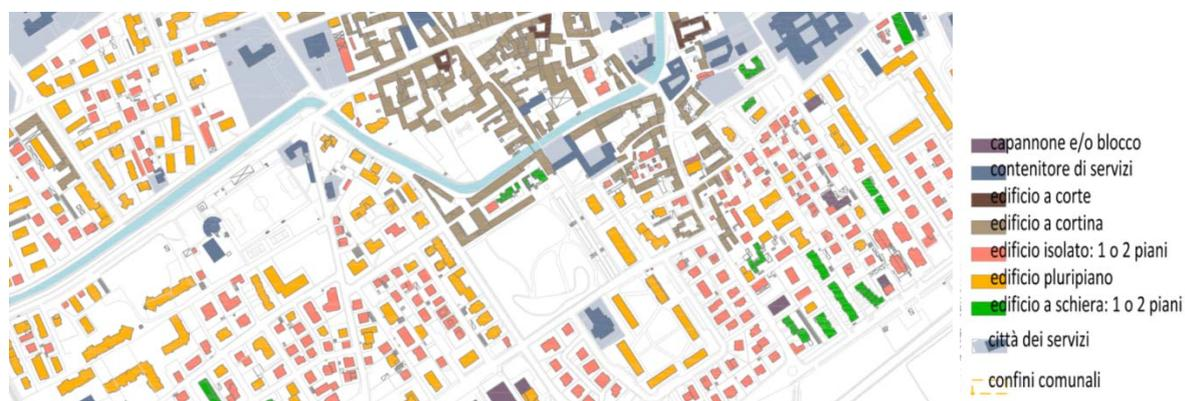
Immagine 3 – Particolare della tavola 3 “Tipologie edilizie degli edifici” individuate a partire dei parametri geometrico-funzionali utilizzati
