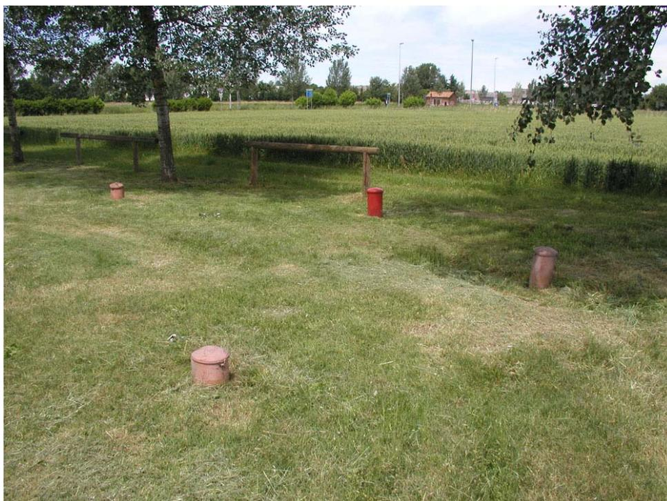
Allo scopo di monitorare le variazioni di umidità nel sottosuolo e dunque ottenere informazioni sulla vulnerabilità della falda per trasmissione verticale ed orizzontale degli inquinanti idroveicolati, i pozzetti sono stati attrezzati con apparecchiature geofisiche per “tomografie elettriche cross-hole (ERT)” e per “misure radar cross-hole (GPR)”.
