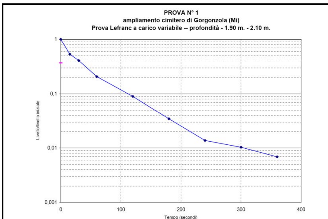
Fig.24: Prova di permeabilità
