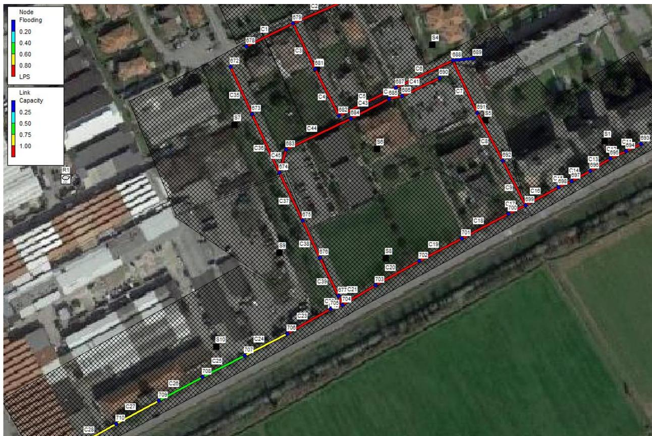
Figura 52 – Planimetria che individua la capacità di flusso del sistema analizzato
