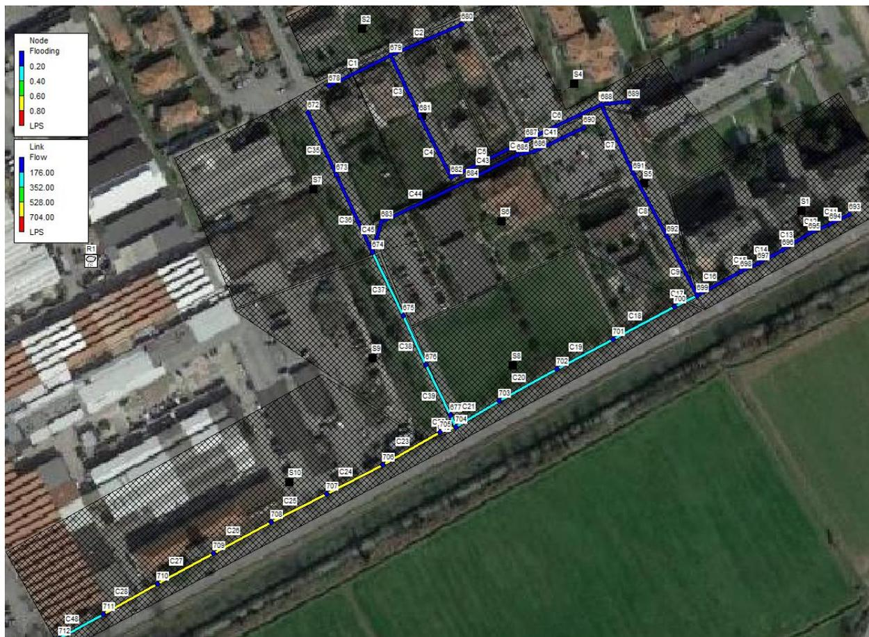
Figura 53 – Planimetria che individua la portata che fluisce nella rete fognaria analizzata
