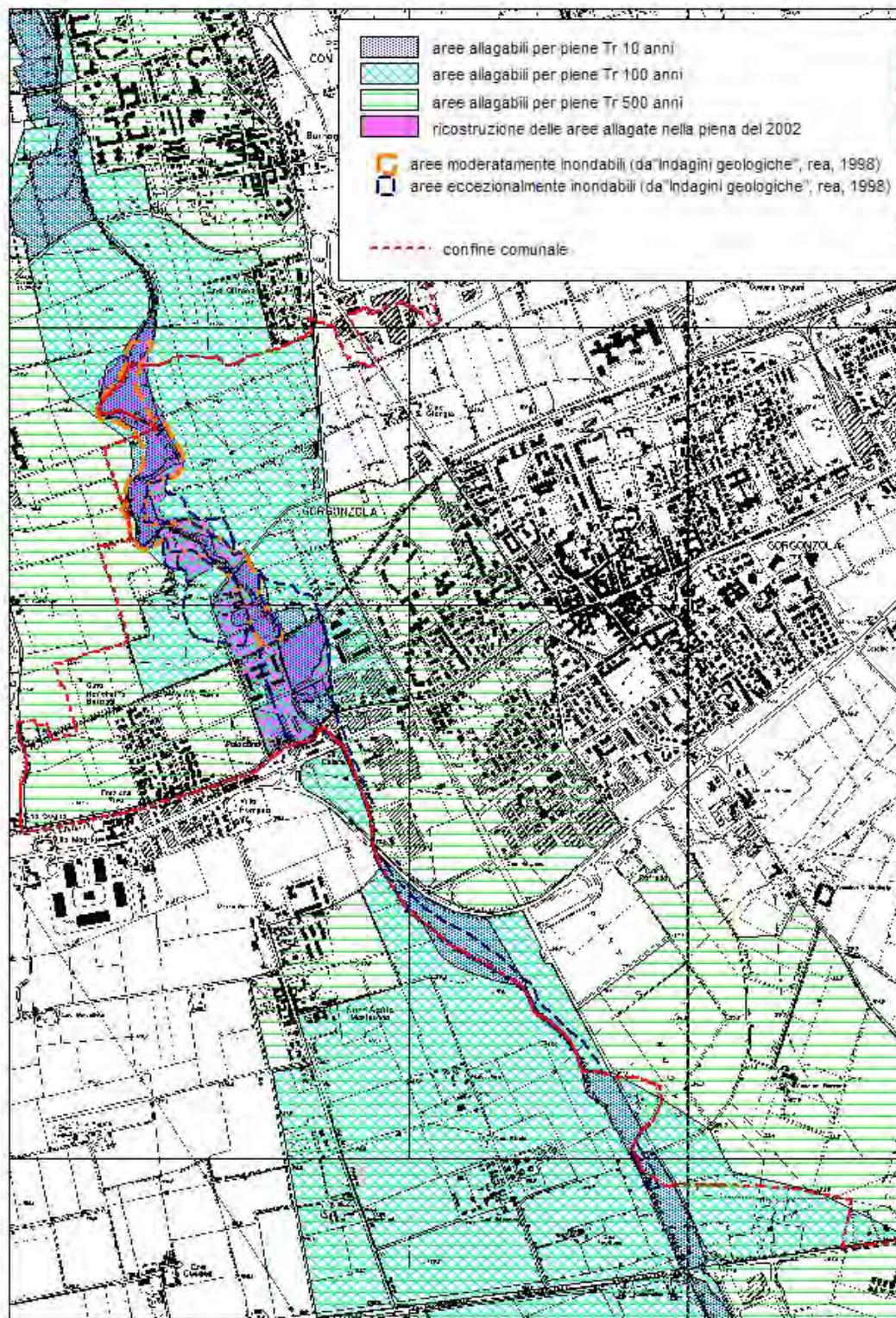
Fig. 4.14: Confronto tra le aree allagabili definite dal modello idraulico dello Studio di fattibilità dell'Autorità di bacino, quelle ricostruite solo in base a criteri geomorfologici (studio rea, 1998) e quelle dell'evento 2002, ricostruite nel presente lavoro
