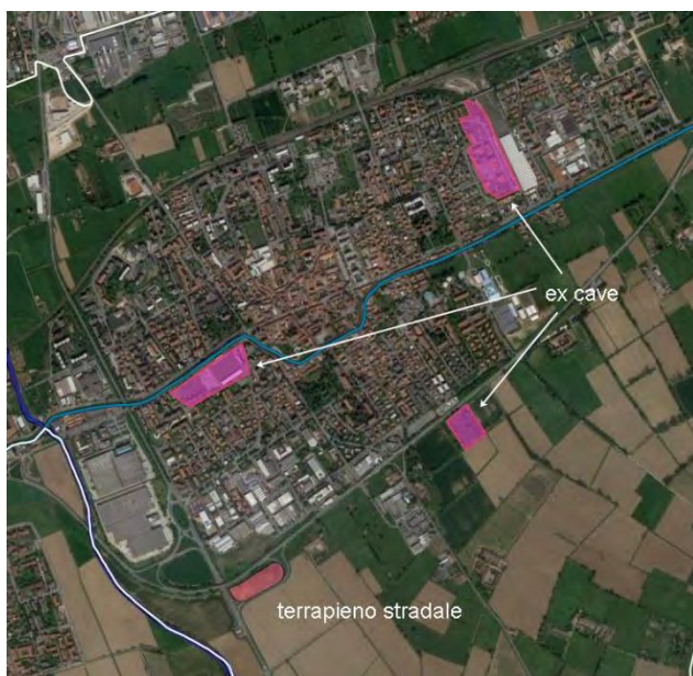
Fig. 10.3 Aree delle ex cave colmate e del terrapieno stradale in corrispondenza dello svincolo SP13-SS11
