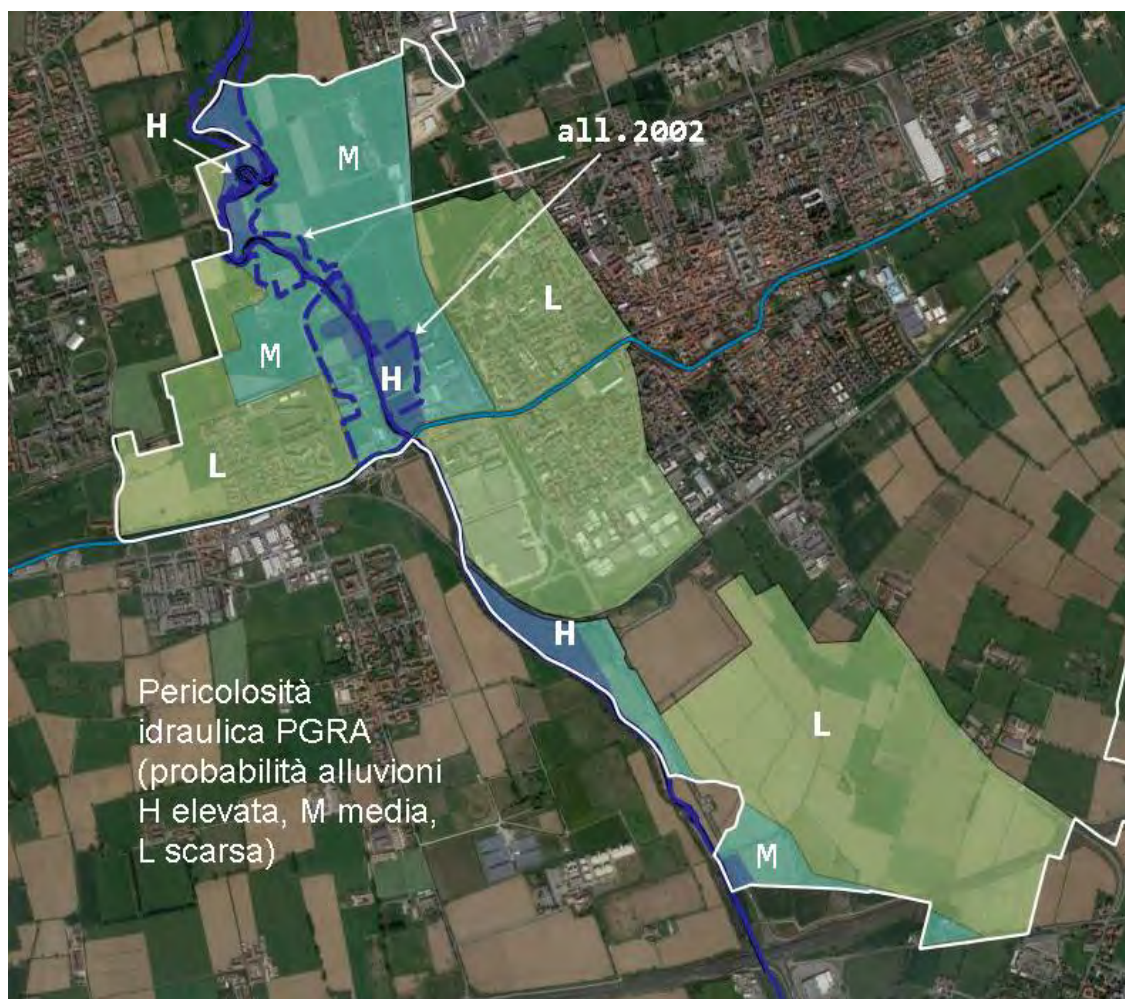
Fig. 10.4 Rappresentazione delle aree inondabili secondo PGRA e delle aree interessate dalla alluvione del 2002
