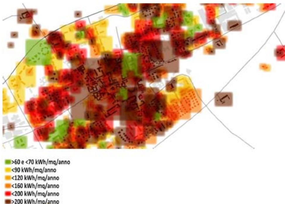
Figura 35: Particolare delle distribuzioni medie del fabbisogno energetico in città - Piano delle Regole - Il modello energetico della città esistente - 2001
