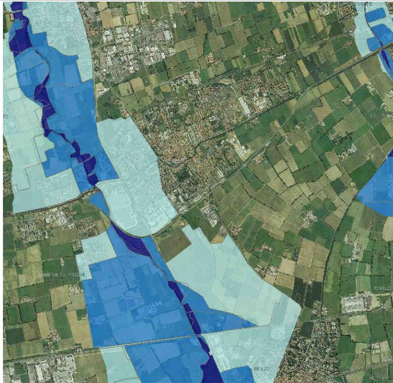
Fig.19 – Carta della Pericolosità Sismica Locale
